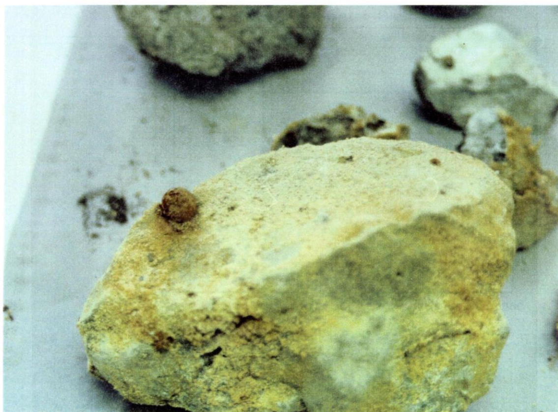
Figuur 7. Witte portlandiet ( \text{Ca}(\text{OH})_2 ) neerslag op staalslak onder uit de semi-praktijk tankopstelling (foto boven). IJzeroxide (bruinrood) en calcië ( \text{CaCO}_3 ; geel) precipitatie op staalslak boven uit de tank (foto onder).
